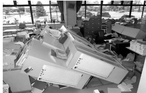
⑪家具什器の転倒（2003宮城県北部地震）：書棚が転倒し避難経路を塞いでいます。
