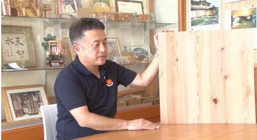
壁倍率 5 倍の 厚さ 60 mm の CLT (明和事務所採用)
