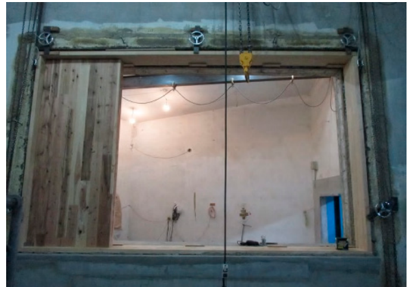
(4) CLTパネル(t=150mm)1枚を取り付けた状況
