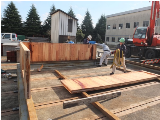
図 3.18 5.5m (強軸方向) ×6m (弱軸方向) の床構面を再現
