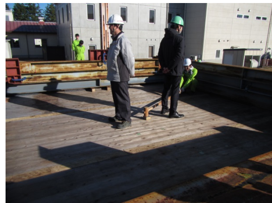
図 3.33 北見モデル:J 点に 1 人、J' 点にもう 1 人乗って K 点加振
