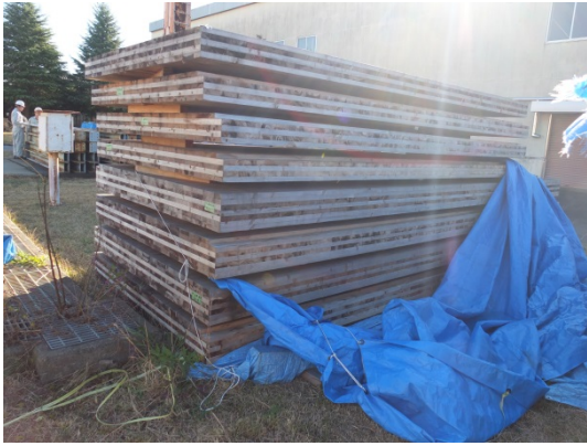
図 3.16 CLT 床板 (5.5m×4m、5層7プライ)
