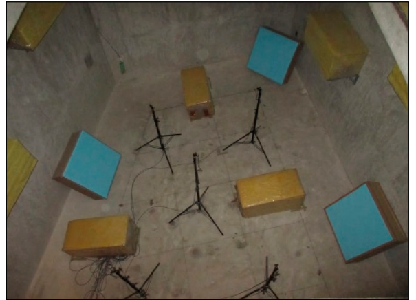
(4) 床衝撃音および音響透過損失(受音側の残響室)
