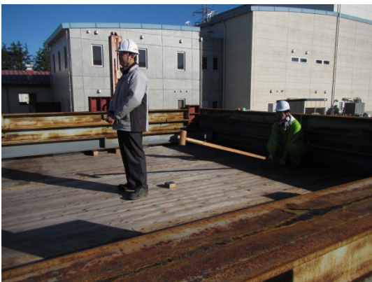
図 3.32 北見モデル:J 点に 1 人乗って K 点加振
