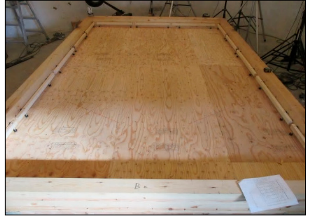
(2) 乾式二重床際根太の割付(試験体No.2-1~2-3)
