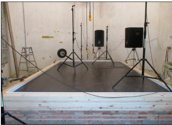
(3) 音響透過損失(音源側)
