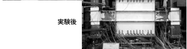
制振壁の周辺部材に要求される性能の評価
